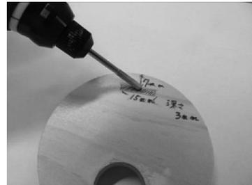
写真6 板を削って深さ5mmの穴を作る
